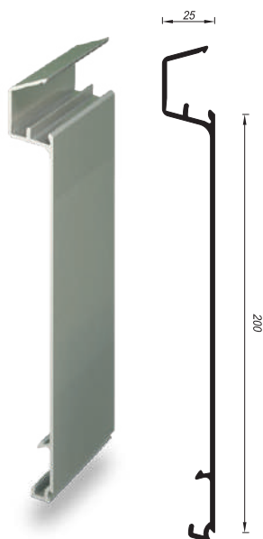
Cod. 05050082 PROFILO PER PARETI PESO (kg/m) 1,670 LUNGHEZZA (m) 7,5
