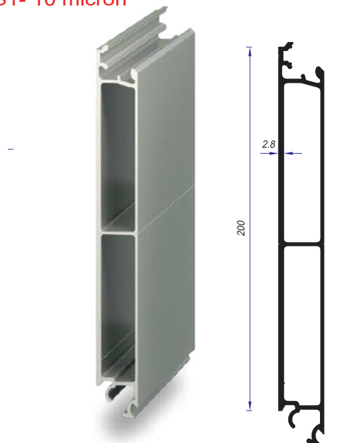
Cod. 05010521 CENTRALE C/SPESSORE DIFFERENZIATO MAGGIORATO DA 200 mm PESO (kg/m) 3,185 LUNGHEZZA (m) 6 / 6,6 / 7,5
